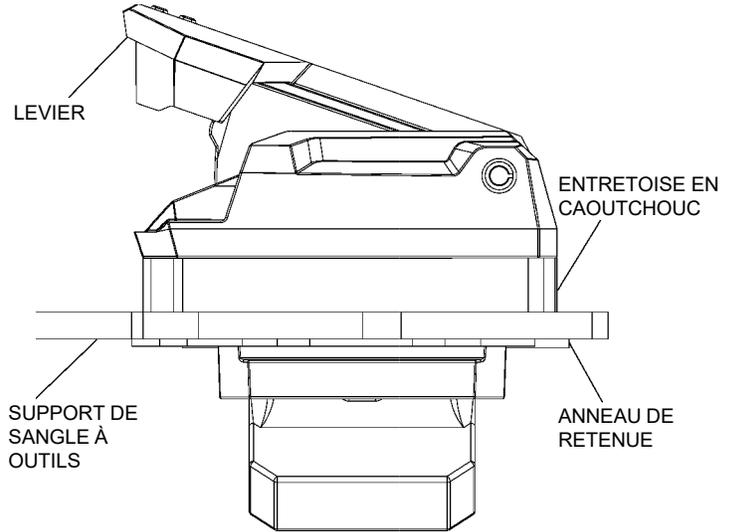
3. Assurez-vous que les leviers du loquet Pro-Connect<sup>MC</sup> sont en position ouverte, puis placez le support de sangle à outils sur la caisse du véhicule (ou accessoire compatible) en alignant chaque loquet Pro-Connect<sup>MC</sup> avec son orifice d'installation correspondant sur la caisse. Verrouillez le support de sangle à outils en place en appuyant sur les deux leviers du loquet Pro-Connect<sup>MC</sup>.
