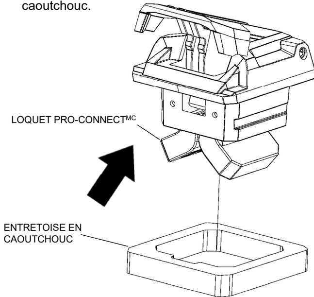
2. Insérez le loquet Pro-Connect<sup>MC</sup> dans les orifices d'installation du support de sangle à outils et fixez-le à l'aide des anneaux de retenue.
